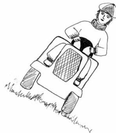
VALE (ümber kukkumise oht)
